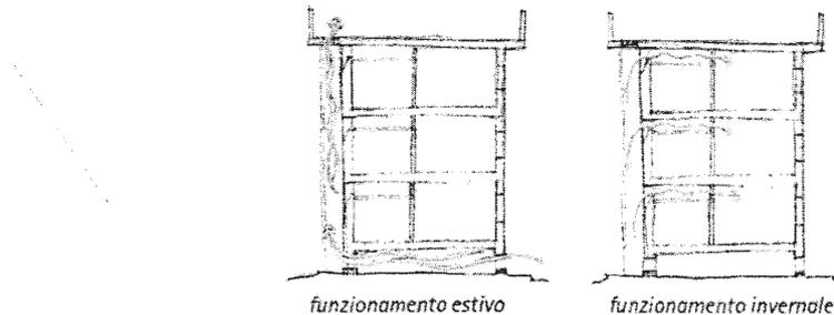
La realizzazione con i sistemi FV di una parete ventilata, permette anche la riduzione dei ristagni di umidità nei locali, come cantinati e interrati, infatti, in questo modo l'aria fredda e umida presente al loro interno viene estratta dal tiraggio naturale o assistito. Vengono così evitati tutti quei fenomeni di degrado dei materiali e delle strutture causati dalla risalita dell'umidità.
