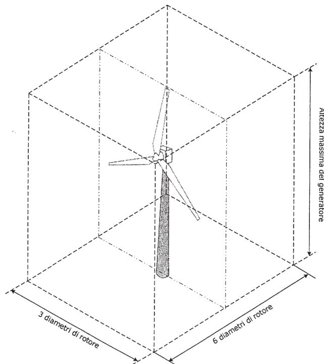
Fig.2.1 - Interpretazione del volume da inserire nel calcolo di  $E_v$
