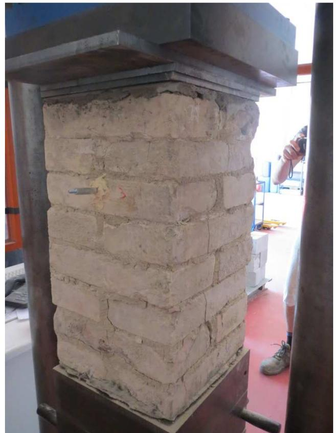
**FOTO 12 – Muretto 1 Fase di incipiente rottura**
