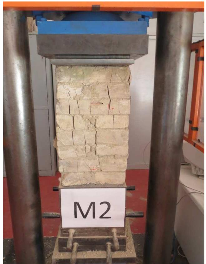
**FOTO 14 – Muretto 2 Fase di incipiente rottura**
