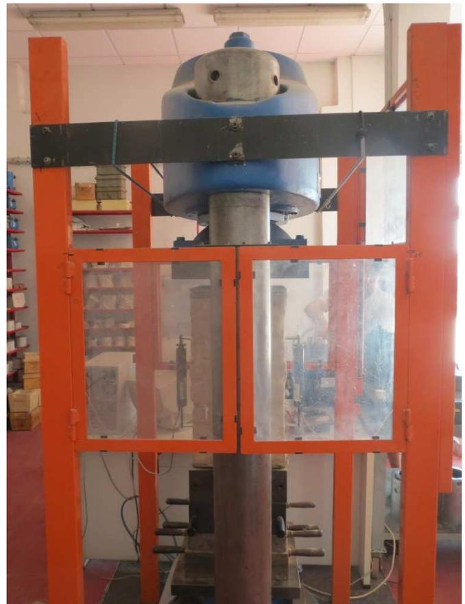
**FOTO 9 – Muretto 1 inserito nel telaio di prova**
