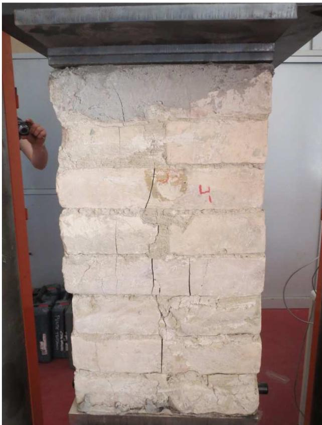
**FOTO 11 – Muretto 1 Fase di incipiente rottura**
