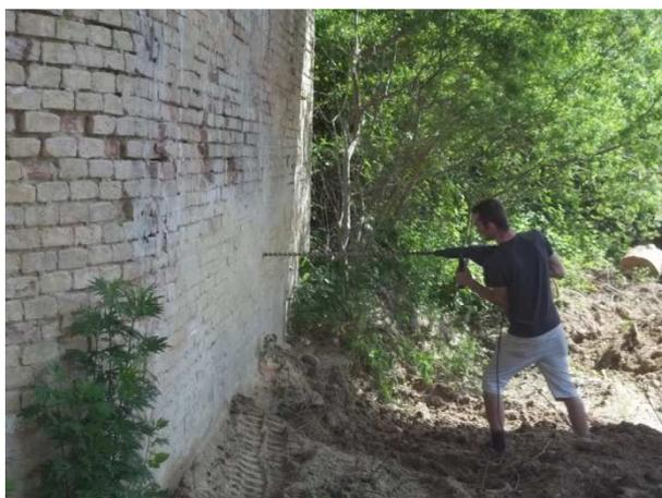
**FOTO 1 – Esecuzione del foro per l'endoscopia E2.**
