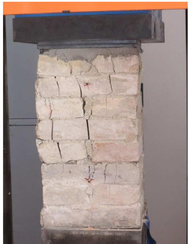
**FOTO 16 – Muretto 3 Fase di incipiente rottura**
