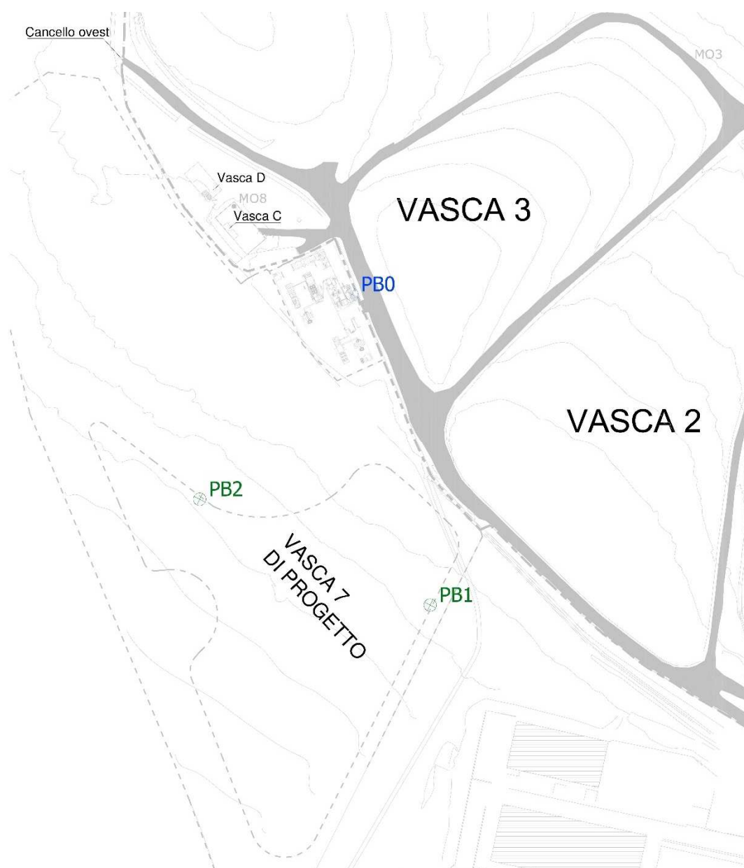
Figura 6 - Stralcio planimetrico dei punti di monitoraggio del biogas
