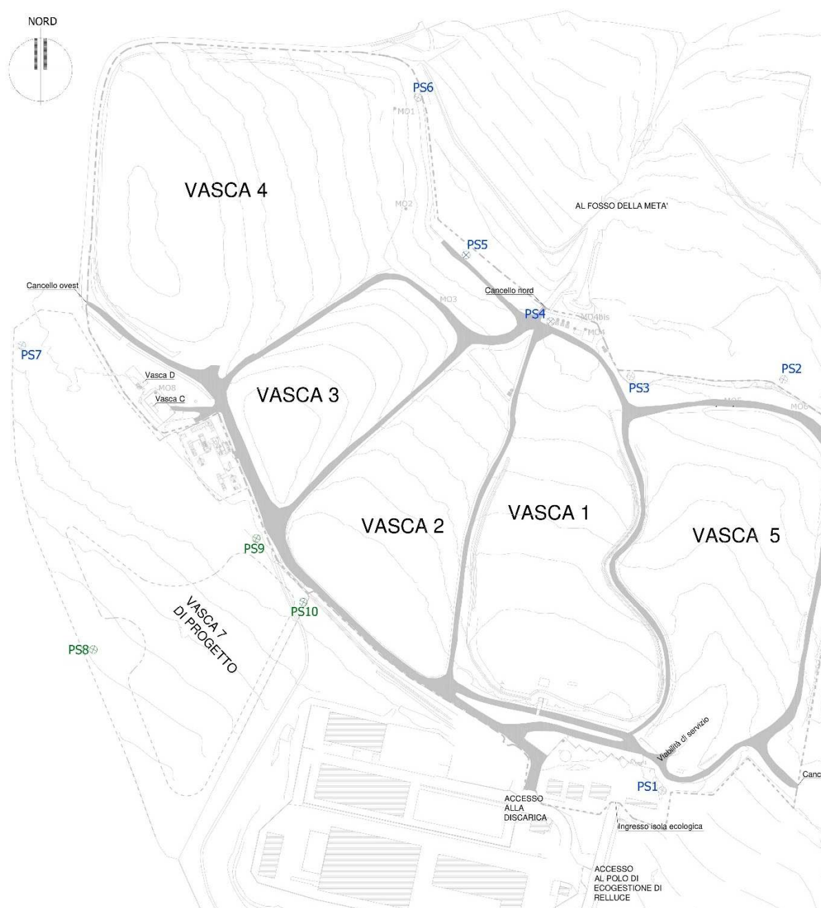
Figura 7 - Stralcio planimetrico punti di monitoraggio acque sotterranee (piezometri)
